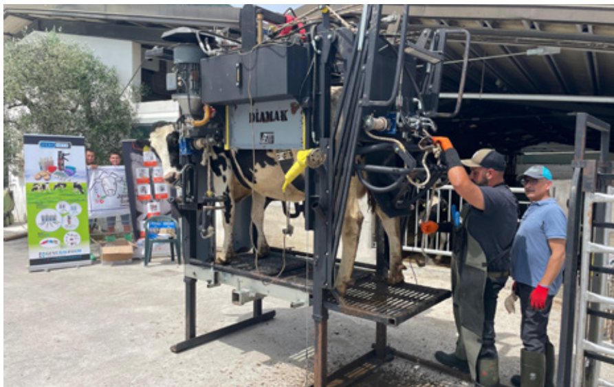
Una visione d'insieme del travaglio: modello che garantisce di operare in sicurezza per il maniscalco e per la vacca
